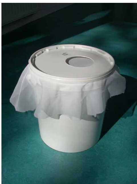
Figure 14 : Eclosoir utilisé pour étudier le parasitisme des oeufs de cicadelles vertes (photo : Fronzes M.)
