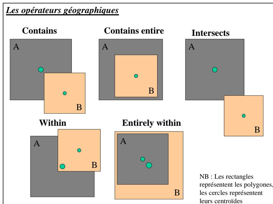
Dans la fenêtre de critères, les objets (A ou B), sont appelés à partir de l'ascenseur **Colonnes** 'nom de couche.obj'. Ce mot clé "obj" indique à MapInfo qu'il doit récupérer des valeurs basées sur des objets graphiques plutôt que des données sous forme de tableaux.
