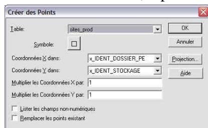
Une fois le fichier ouvert, observez sa structure. La présence de coordonnées X et Y va nous permettre de créer pour chaque ligne du tableau un point avec les coordonnées correspondantes.
